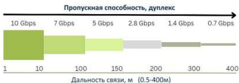
Рис. 5: Зависимость пропускной способности Мобибридж 10G от дальности связи
