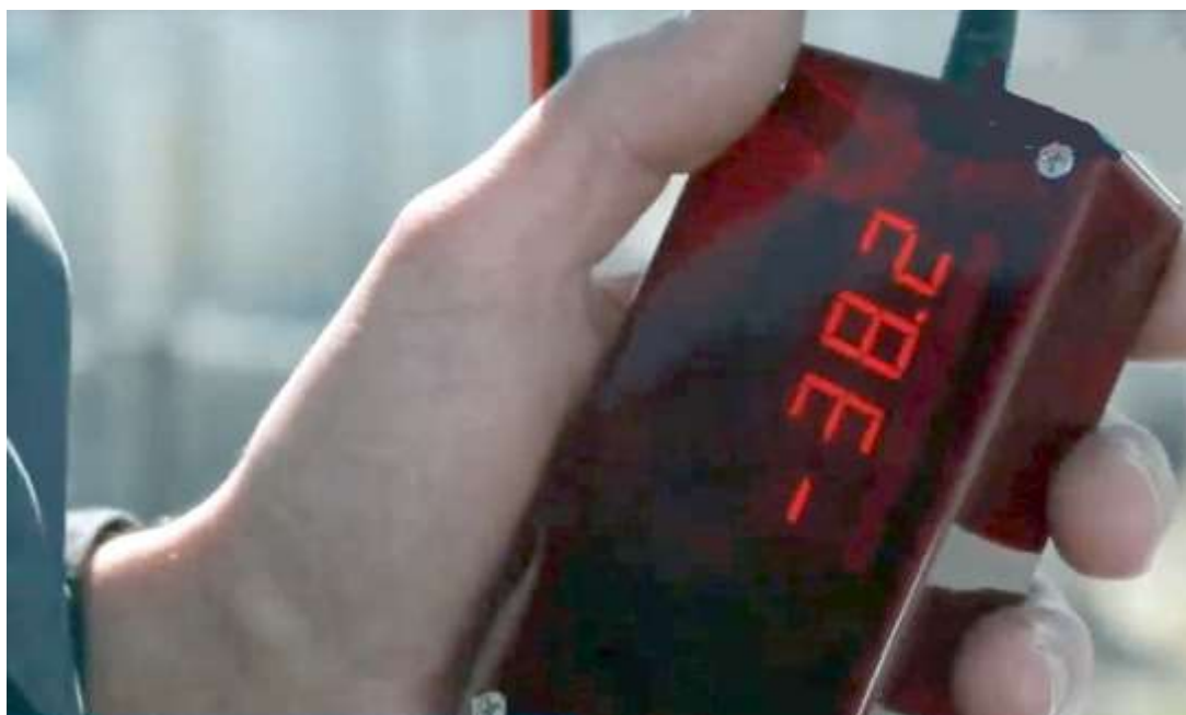
Рис. 5. Значение RSL из калькулятора используется при юстировке антенн с помощью пульта
