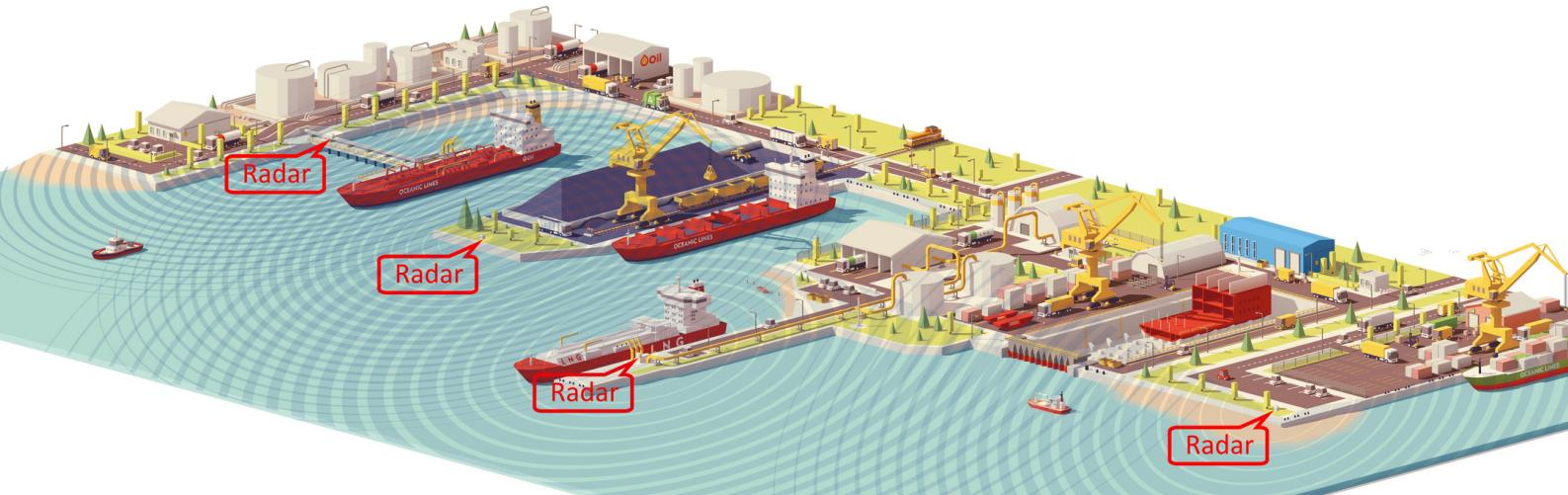
РЛС "СИД-360-76" могут быть установлены вдоль причалов для наблюдения за ближней зоной водной акватории и контроля швартовки судов с передачей данных в центр управления портом
