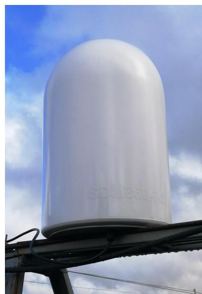
РЛС "СИД360-76" диапазона 76 ГГц имеет изначально более высокое разрешение, чем радары S, X или даже К-диапазона, которые обычно используются для судовождения и мониторинга акватории.
