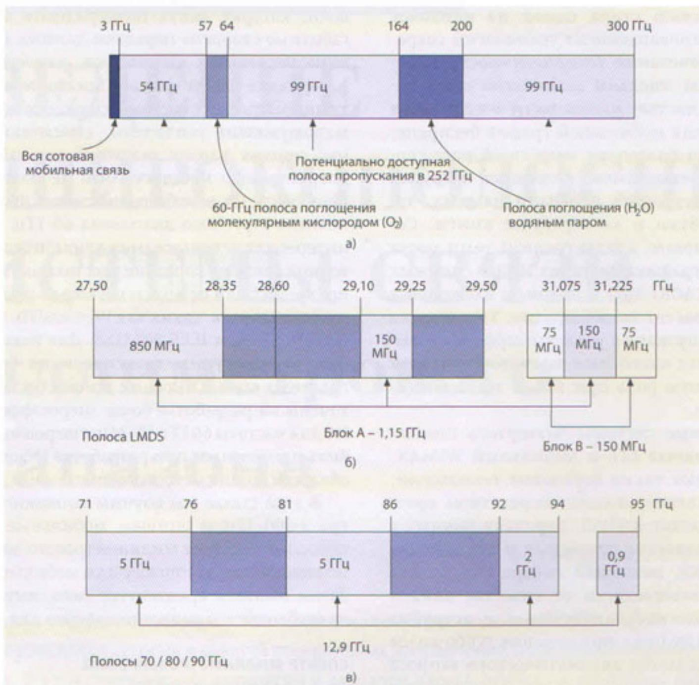
**Рис.1.** Спектр в миллиметровом диапазоне: **а** – полосы, доступные для широкополосной мобильной связи; **б** – лицензируемые диапазоны LMDS; **в** – Е-диапазон
